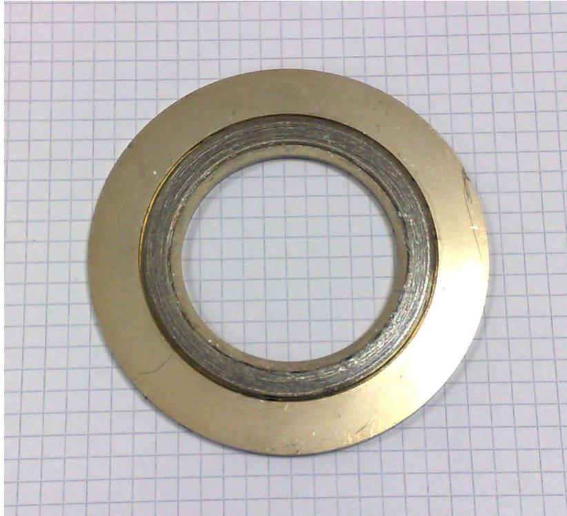
Bild 1: Prüfmuster nach Demontage
