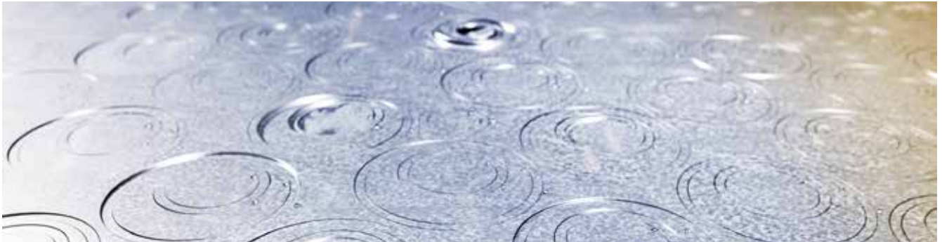
Laserzuschnitte – Rohlinge für die Kammprofil- und Spiraldichtungsfertigung
