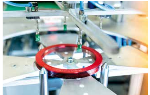
Automatische Laserbeschriftung der Dichtungskennung
