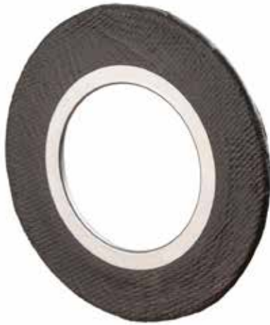
Kammprofil mit Gewebeauflage, Innenbördel und Grafit-Elastomer-Imprägnierung
